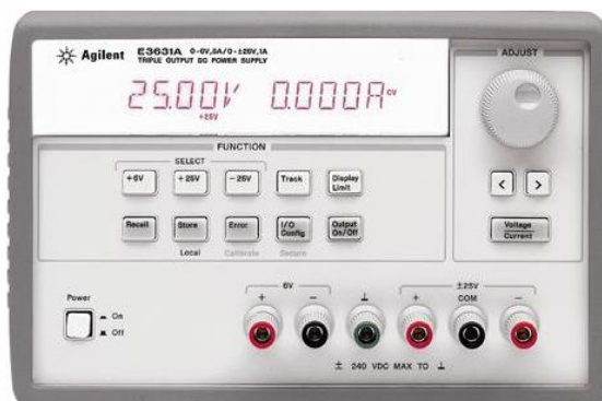
Obr. 3.5: Zdroj napětí obou polarit Agilent E3631A pro modulátor
