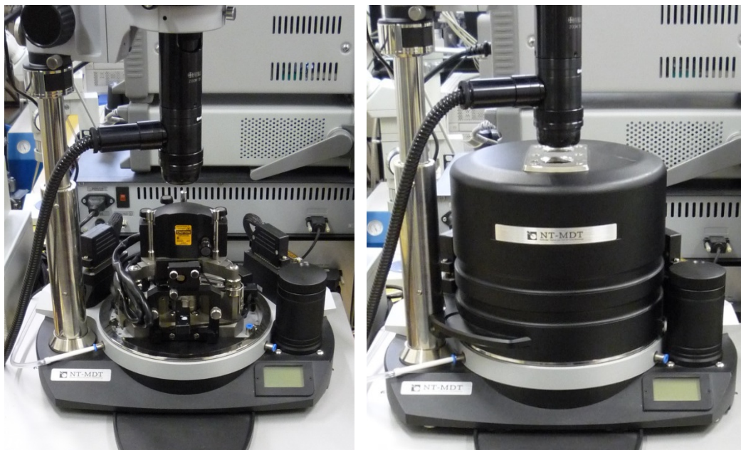
Obr. 3.1: Mikroskop AFM NT-MDT Smena bez poklopu při manipulaci a s poklopem při skenování nebo litografii
