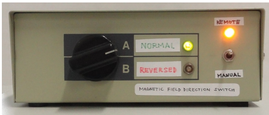
Obr. 3.15: Ovládací panel křížového přepínače
